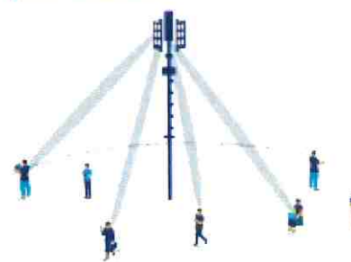
Antenne active 5G avec système d'émission et réception directionnel des signaux fréquences > 1GHz
