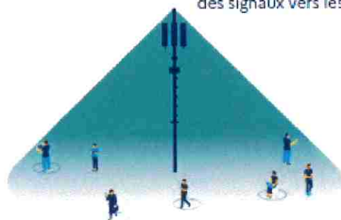
Antenne passive 2G | 3G | 4G | 5G sans système d'émission et réception directionnel des signaux fréquences < 1GHz
