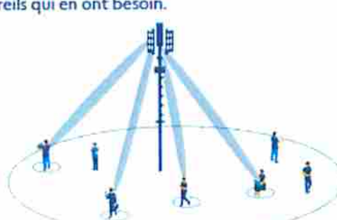
Antenne active 5G avec système d'émission et réception directionnel des signaux fréquences > 1GHz
