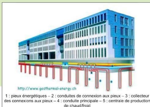
Le principe du pieu géothermique
