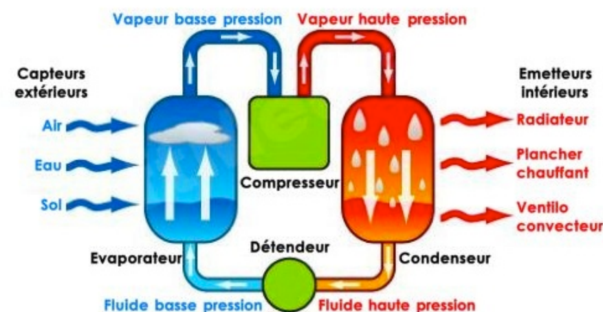
Figure 14 : Le principe de fonctionnement d'une pompe à chaleur
