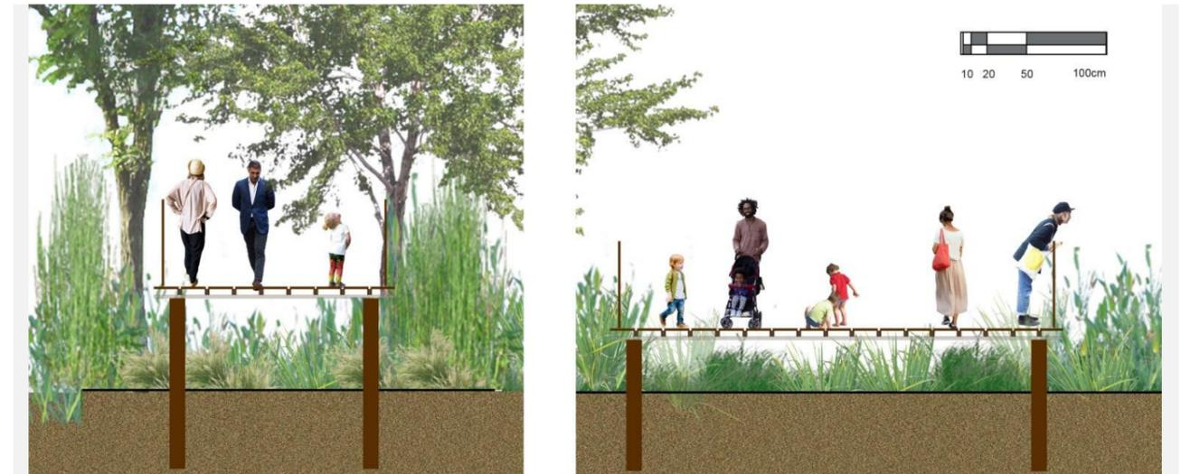
Figure 35 : Coupe sur les pontons bois vers le canal. (Source : Agence Babylone, exemples avec pieux battus)
